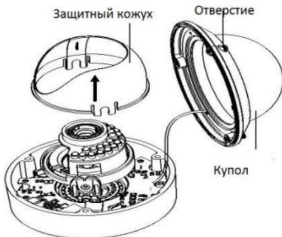
Рисунок 2-1 Снятие купола и защитного кожуха
