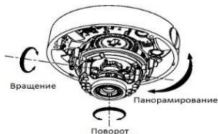
Рисунок 2-14 3-х осевая регулировка
